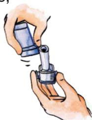
**2.** Tournez l'embout en suivant le sens des flèches: le creux pour la capsule deviendra apparent. Placez-la dans ce creux et faites tourner à nouveau le tube jusqu'à sa position initiale.
